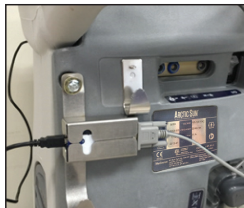
Fig. 8-74 Insira o TIM e ligue os cabos (Passos 3-5)
