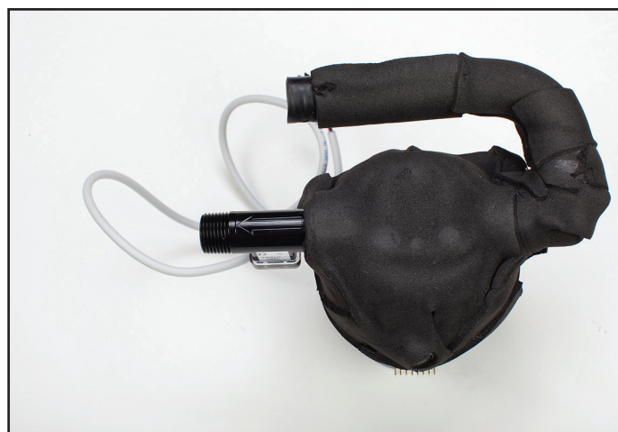
Fig. 8-53 Fluxómetro com seta a indicar a direção do fluxo; a mesma direção da saída da bomba de circulação
